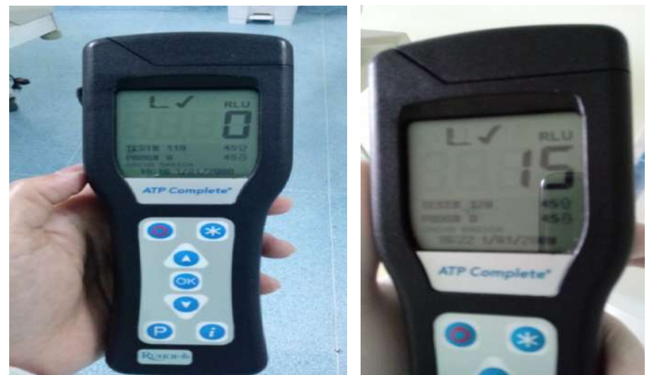
Resultados do swab dos quartos 1006 e 1007, utilizando o equipamento Ruhof ATP Complete.
